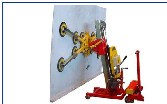
**Монтажный лифт с вакуумным захватом для вертикального подъема и транспортировки с сохранением стабильной поверхности ручного поворота на +/- 360 градусов ручного наклона на +20 /-50 градусов**
