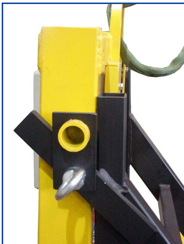
Крепление устройства Kombi 7211-DS3 на транспортной раме 7003-GTGDS3 (вид сбоку)
