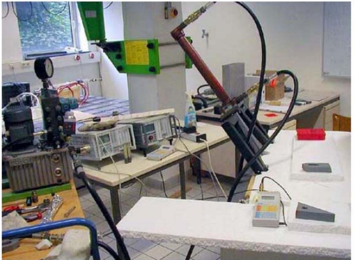
На фото испытание присосок при низких температурах
