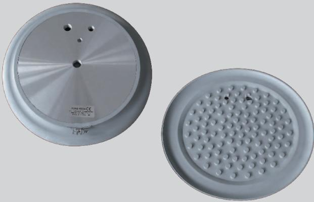
Плоские присоски Тип BLSP 250 COP. Уплотнитель съёмный, крепится зажимом. Уплотнитель изготовлен из чёрного бутадиен-нитрильного каучука (БНК), диаметр 250 мм. Твёрдость по Шору ок. 50.
