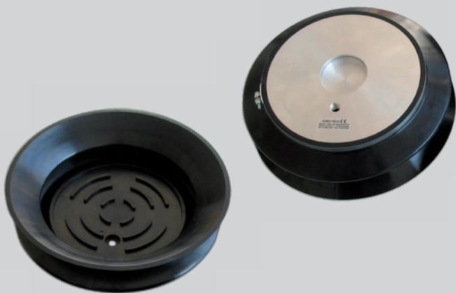
Гофрированные присоски Тип BBSC 285. Очень эластичные. Для универсального использования, особенно для автоматических систем перемещения стекла. Уплотнитель имеет диаметр 280 мм, изготовлен из чёрного бутадиен-нитрильного каучука (БНК). Твёрдость по Шору ок. 50. Подходят для гнутых и ровных поверхностей. Уплотнитель хорошо сжимается, поскольку гофра имеет 1,5 складки. Уплотнитель съёмный. Крепится зажимом. Отверстия под крепёж можно адаптировать под требования заказчика.
