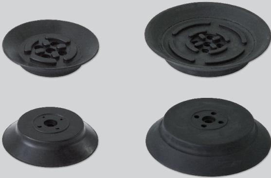
Уплотнитель Тип BSP Серии CO. Уплотнитель изготовлен из бутадиен-нитрильного каучука (NBR). Твёрдость по Шору ок. 50. Подвес и основа могут быть изготовлены по спецификации заказчика. Уплотнитель фиксируется четырьмя болтами.
