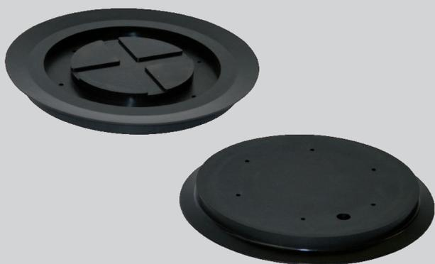
Уплотнитель Тип BSP 285 CEM. Диаметр 285 мм. Уплотнитель изготовлен из бутадиен-нитрильного каучука (NBR). Твёрдость по Шору ок. 50. Крепится внутренним стальным кольцом с шестью болтами.
