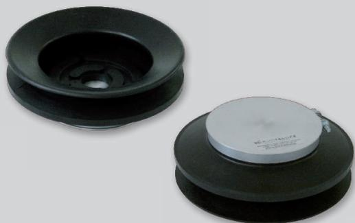
Гофрированные присоски Тип BBSC 150 R повышенной износостойкости для универсального использования. Уплотнитель имеет диаметр 150 мм, изготовлен из чёрного бутадиен-нитрильного каучука (БНК). Эластичность материала позволяет уплотнителю плотно прилегать к неровным поверхностям. Данная модель подходит для грузозахватных устройств в стекольной отрасли. Уплотнитель съёмный. Крепится зажимом.
