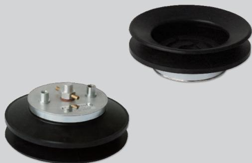
Гофрированные присоски диаметром 150 мм. Уплотнитель изготовлен из чёрного бутадиен-нитрильного каучука (БНК). Гофра - 1,5 складки. Алюминиевая основа имеет резьбовое отверстие 1/4", два вывода с резьбой М6 и мини-эжектор (дополнительно). Подходит для оборудования складирования и перемещения стекла.
