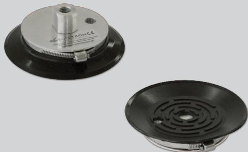
Плоская присоска Тип BLSP 95 L - BY. Диаметр 95 мм. Уплотнитель сменный, крепится зажимом. Изготовлен из чёрного бутадиен-нитрильного каучука (NBR). Алюминиевая основа имеет боковое резьбовое отверстие 1/8" для вакуумного коннектора.
