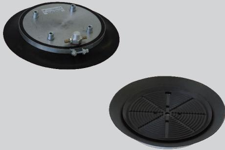
Плоские присоски Тип BLSP 200 PK-BY. Уплотнитель изготовлен из чёрного бутадиен-нитрильного каучука (БНК), диаметр 200 мм. Твёрдость по Шору ок. 50. Уплотнитель съёмный. Крепится зажимом. Основа из алюминия имеет мини-эжектор Тип BDCN-DJ и выводы с резьбой. В большинстве случаев, присоски используются в вакуумных захватах. Отверстия можно адаптировать под требования заказчика.
