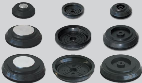
Гофрированные присоски Тип BBSC Серии В. Очень эластичные. Для универсального использования. Уплотнитель имеет диаметр 150/ 210/ 250 мм, изготовлен из чёрного бутадиен-нитрильного каучука (БНК). Твёрдость по Шору ок. 60. Подходят для гнутых и ровных поверхностей. Уплотнитель хорошо сжимается, поскольку гофра имеет 1,5 складки. Подходит для автоматических систем перемещения стекла. Уплотнитель съёмный. Крепится зажимом.
