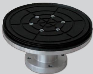
Поворотная присоска Тип BLSP 200 BY. Состоит из алюминиевой опоры с фланцем. Фланец D 100 мм имеет четыре отверстия D 8,4 мм для крепления на поворотную пластину станка. Верхняя часть присоски имеет съёмное основание D 185 мм, толщиной 8 мм. Уплотнитель сменный, изготовлен из чёрного бутадиен-нитрильного каучука (БНК). Общая высота присоски 105 мм.
