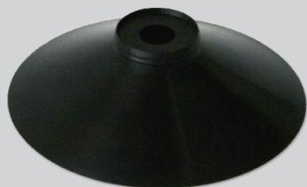
Плоская присоска Тип 105 HG. Диаметр 105 мм. Уплотнитель несъемный, изготовлен из чёрного бутадиен-нитрильного каучука (NBR). Твёрдость по Шору ок. 75. Центральное отверстие D 12,5 мм. Присоска может быть укомплектована втулкой BSCN-HG.105.01 и кольцом BSCN-HG.105.02.
