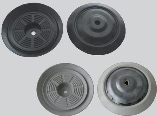
Эластичные и износостойкие присоски Тип BSP 145 PK. Уплотнитель несъемный, из чёрного или серого бутадиен-нитрильного каучука (БНК), диаметр 145 мм. Присоска крепится на болт гайкой изнутри. Большой коэффициент трения предотвращает скольжение стекла, особенно, когда стекло находится в вертикальном положении.
