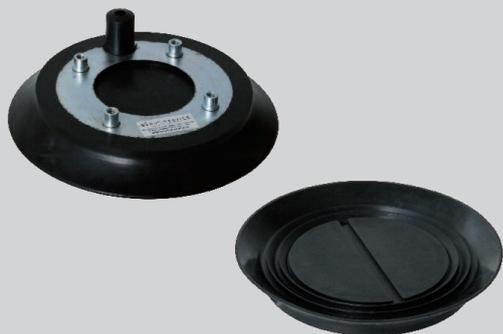
Плоские присоски Тип BLSP 200 PK. Уплотнитель изготовлен из чёрного бутадиен-нитрильного каучука (БНК), диаметр 200 мм. Твёрдость по Шору ок. 50. Уплотнитель несъёмный. Основа из стали имеет 4 вывода с резьбой М6 и резиновый ниппель для вакуумного соединения. В большинстве случаев, присоски используются в вакуумных захватах.
